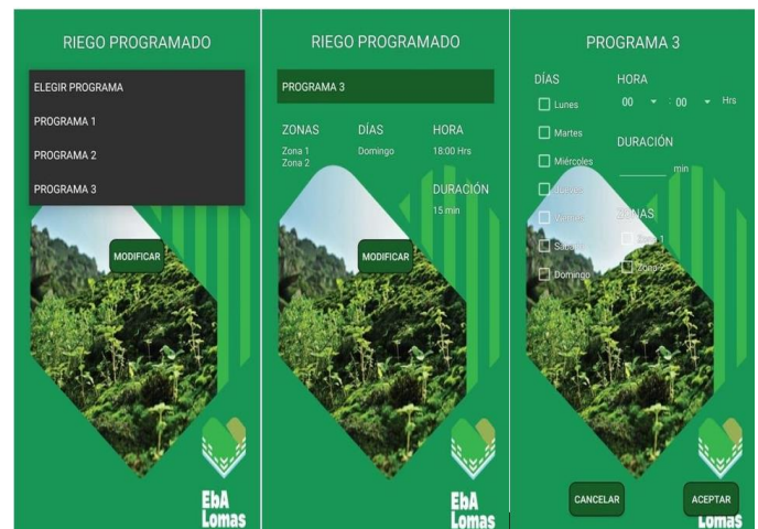
Fig. 20. Vistas del aplicativo móvil para monitoreo y programación de riego
