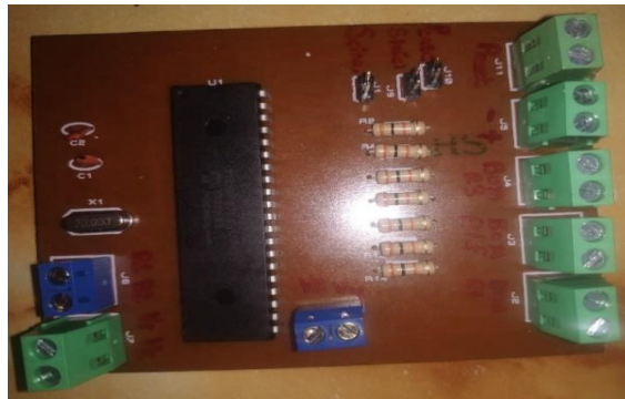
Fig. 17. Implementación del controlador de llenado de tanques sobre un PCB
