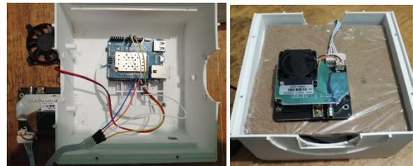
Fig. 3. Prototipo de sistema de monitoreo de PM.
