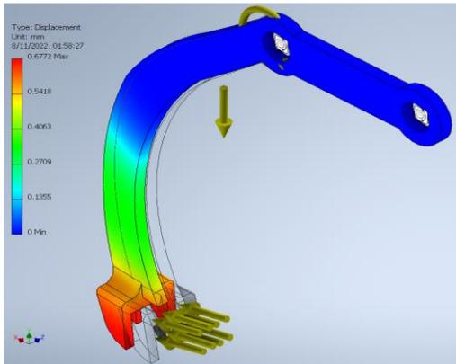
Fig. 12 Maximum displacement.
