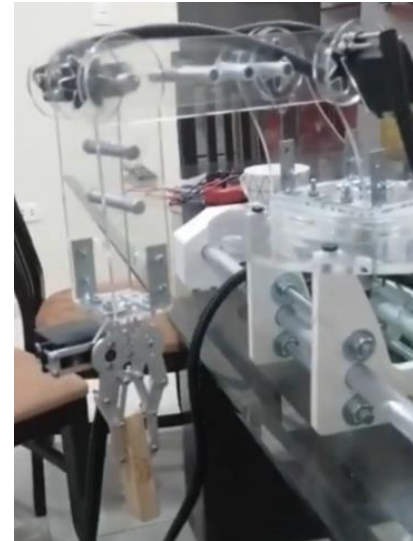
Fig. 13 Sujeción del objeto a través del proceso de transporte.
