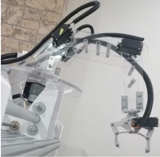
Fig. 7 Diseño en acrílico del brazo robótico
