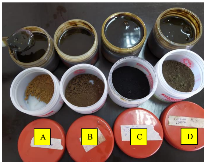
Fig. 2 Productos líquidos (hidrocarburos) y sólidos de la pirólisis. A) 450 °C, B) 500 °C, C) 550 °C y D) 600 °C.
