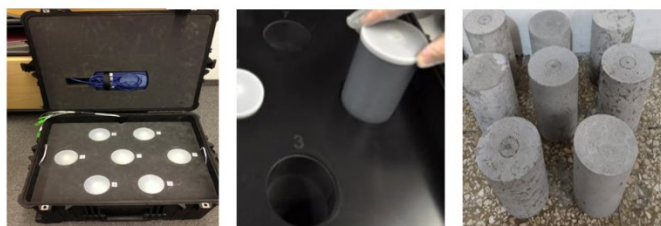
Figura 3 Pruebas Calorimétricas en Probetas de Mortero
