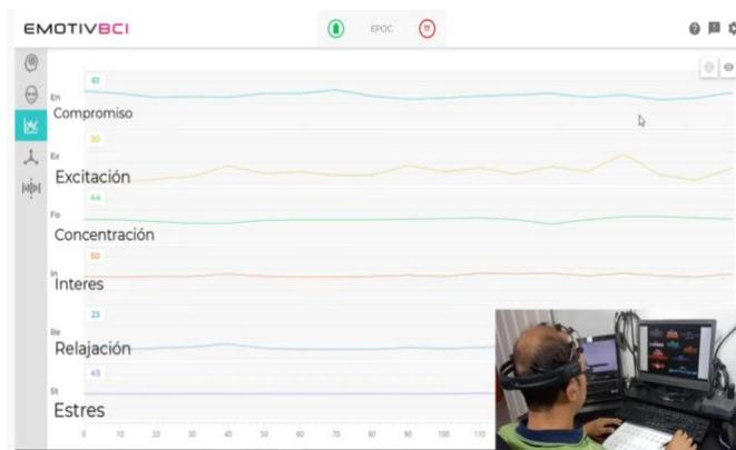
Fig. 3 Captura de señales con Emotiv EPOC X
