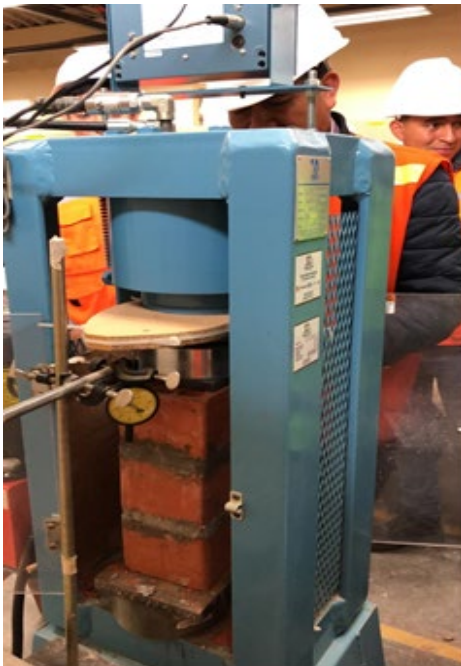
Fig. 3: Ensayo de resistencia a la compresión en pilas de albañilería.
