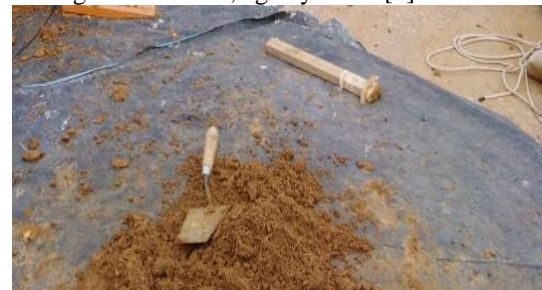
Figura 6. Mezcla homogénea de tierra, fibra y agua; Tomada de: “Resistencia a compresión, flexión y absorción del adobe compactado con fibra de pino; Cajamarca 2019” por Vasquez, L. 2021. [1].
