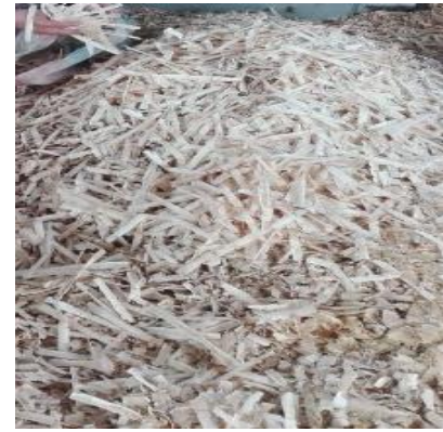
Figura 5. Dosificación de la Fibra de pino; Tomada de: “Resistencia a compresión, flexión y absorción del adobe compactado con fibra de pino; Cajamarca 2019” por Vasquez, L. 2021. [1].
