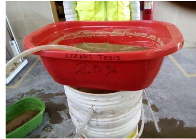
Figura 11. Ensayo de absorción; tomada de: “Resistencia a compresión, flexión y absorción del adobe compactado con fibra de pino; Cajamarca 2019” por Vasquez, L. 2021. [1].
