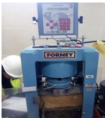
Figura 10. Ensayo de flexión; Tomada de: “Resistencia a compresión, flexión y absorción del adobe compactado con fibra de pino; Cajamarca 2019” por Vasquez, L. 2021. [1].
