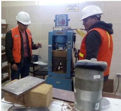
Figura 9. Ensayo a compresión; Tomada de: “Resistencia a compresión, flexión y absorción del adobe compactado con fibra de pino; Cajamarca 2019” por Vasquez, L. 2021. [1].
