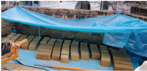
Figura 8. Almacenamiento y secado; Tomada de: “Resistencia a compresión, flexión y absorción del adobe compactado con fibra de pino; Cajamarca 2019” por Vasquez, L. 2021. [1].
