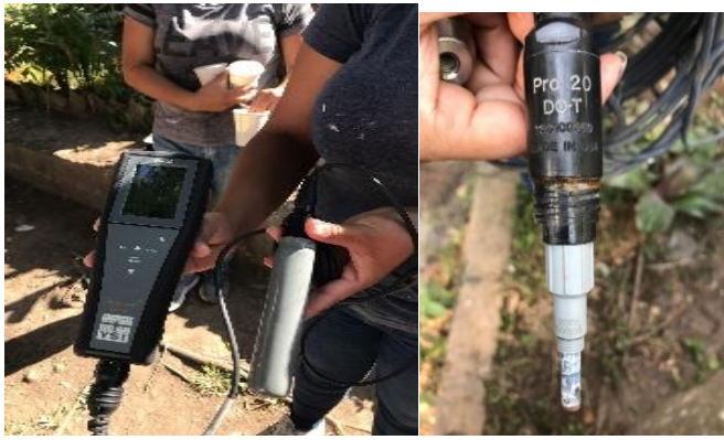
Fig. 7 Equipo utilizado para realizar mediciones manuales de oxígeno disuelto en estanques de tilapia.
