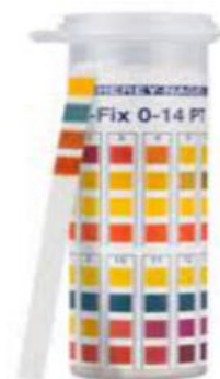
Fig. 6 Tubo de tiras para medir PH utilizado en las mediciones diarias de la calidad del agua en los estanques de tilapia.
