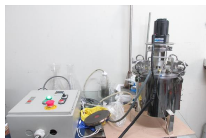
Fig. 8. Reactor biológico de 5 L en acero inoxidable.
