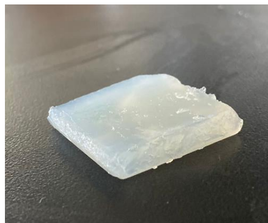
Fig. 3. Hidrogel obtenido de la formulación desarrollada usando PEG200 para la extracción ácido hialurónico (AH) como agente entrecruzante, agua (60%) y una mezcla de glutaraldehído (GA) 2.5% y dimeticona como aditivos.
