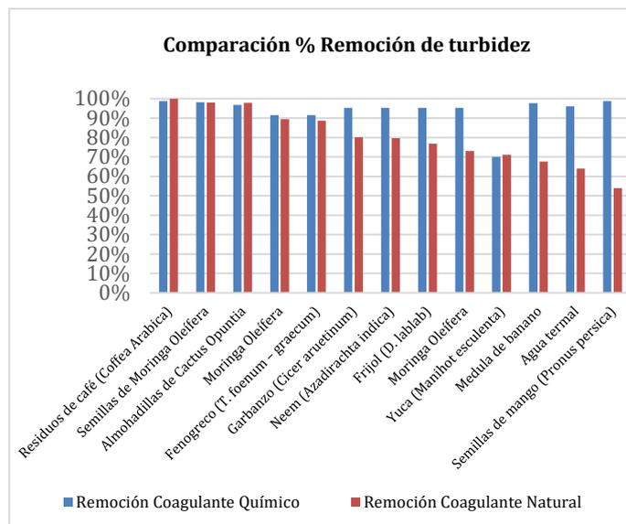
Fig. 3. Comparación entre coagulantes naturales y Sulfato de aluminio
